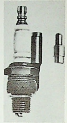
Afb. 17. Bougie met aangebouwde piezokwarts omzetter (druk in el. spanningen) (Werkfoto A.V.L. - Oostenrijk).
